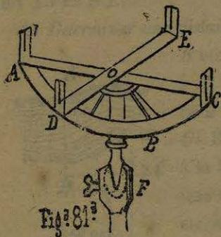
pínulas fijas en *A* y *C*, perpendiculares á su plano, y otras dos móviles *D* y *E*, que van unidas á una alidada cuyos extremos tienen vernieres para apreciar las fracciones de la graduación. Todo el sistema se apoya en una *rodilla F* para fijarlo al tripié.
