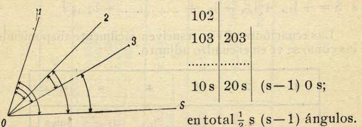
Llamemos á los ángulos medidos  $l_{1,2}$ ,  $l_{1,3}$ ,  $l_{1,s}$ ,  $l_{2,3}$ ,  $l_{2,s}$ , .....  $l_{(s-1)s}$ , y designamos por X, A, B, C, ..., S, las direcciones más probables de las visuales á los vértices 1, 2, 3, ..., s; tendremos las siguientes ecuaciones de condición:
