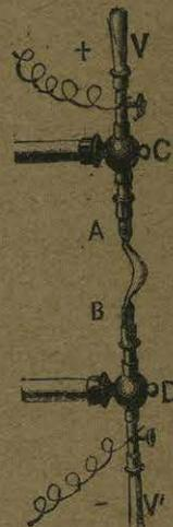
Fig. 351. El arco voltaico.
