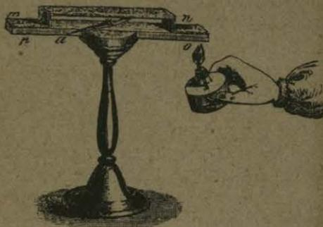
Fig. 349. Par termoeléctrico de Seebeck.
