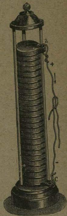
Fig. 340. Pila de Volta.]
