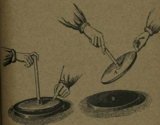
Fig. 312. Funcionamiento del electróforo de Volta.
