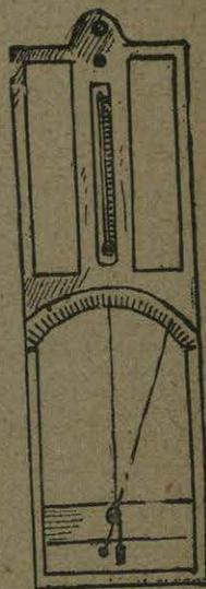
Fig. 289. Higrómetro de *cabello*.
