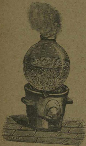
Fig. 267. Las burbujas se forman en el seno del líquido y revientan en la superficie.
