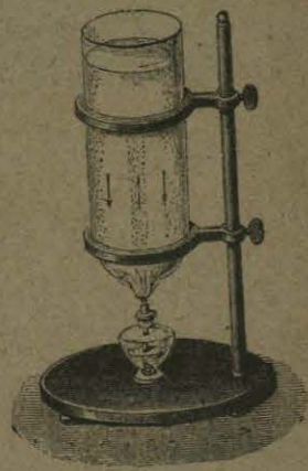
Fig. 259. Los líquidos se calientan por convección.
