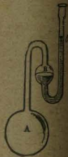
Fig. 243. El calor aumenta la fuerza elástica del gas.
