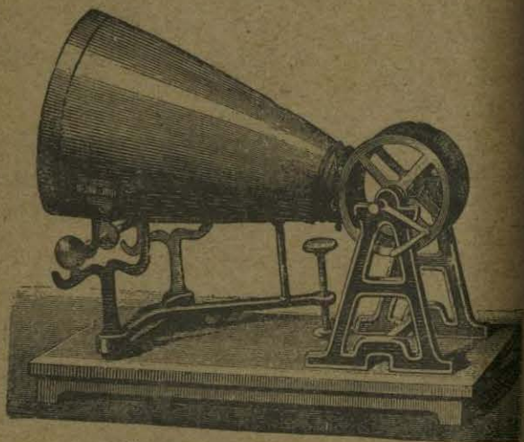
Fig. 153. El fonotógrafo de Scott.
