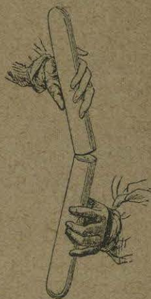
Fig. 101. Los gases pueden pasarse de un vaso á otro.
