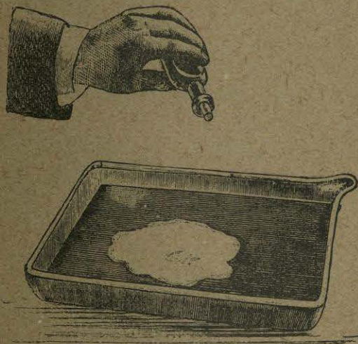
Fig. 92. Igualdad de tensión en todos sentidos.
