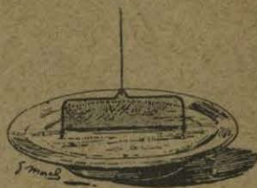
Fig. 89. Medida de la tensión superficial.
