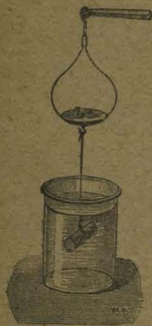
Fig. 71. Se pesa el cuerpo en el agua.
