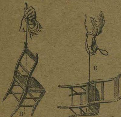
Fig. 33. Determinación del centro de gravedad.
