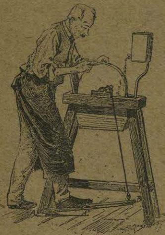
Fig. 43. Ejemplo de palanca de tercer género.
