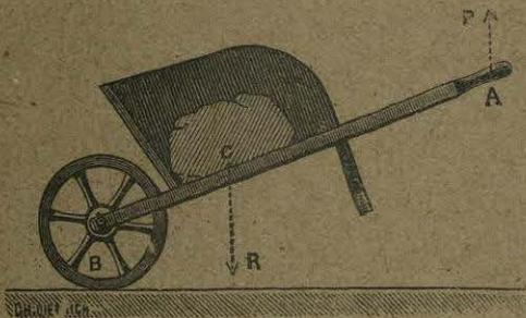
Fig. 42. Ejemplo de palanca de segundo género.
