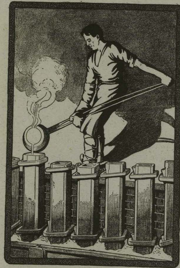
FIG. 28. — Pouring ingots from crucibles.
