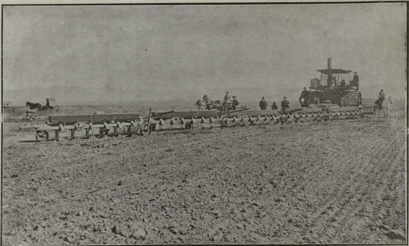
Fig. 14.— Arados sembradores tirados por máquina de vapor
