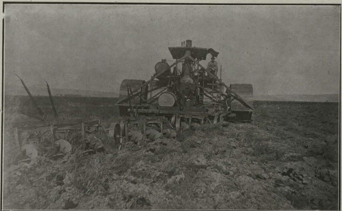
Fig. 7.— Arados multirrejas arrastrados por máquina de vapor
