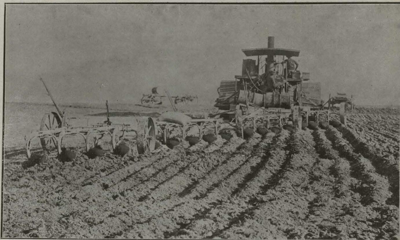
Fig. 8.—Arados de cuatro rejas tirados por máquina de vapor
