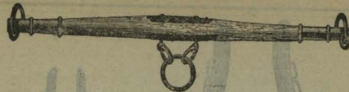
Bolea de pecho para la lanza de los carros y cultivadoras
