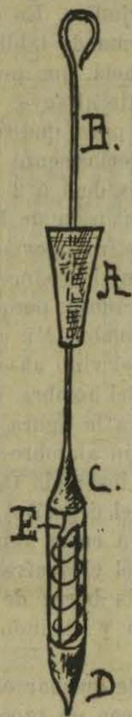
Fig. 22.—Aparato para azufrar el barril
