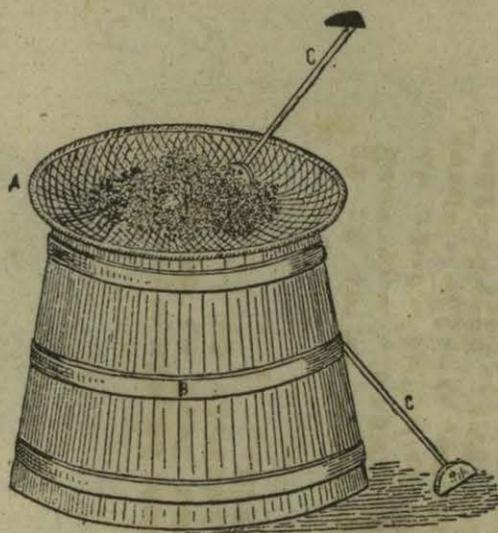
Fig. 1.—Cernidor para separar el grano de la raspa
